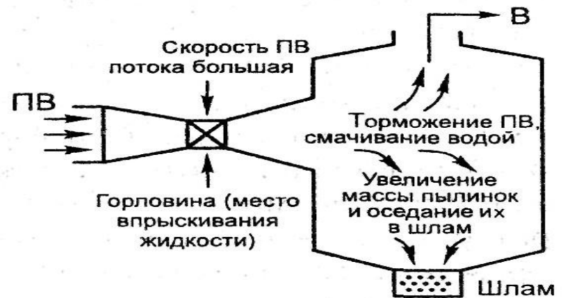
Рис. 2.13. Мокрые пылеуловители: а, а' — пенные аппараты; б, б' — соответственно форсуночный скруббер и скруббер (труба) Вентури
