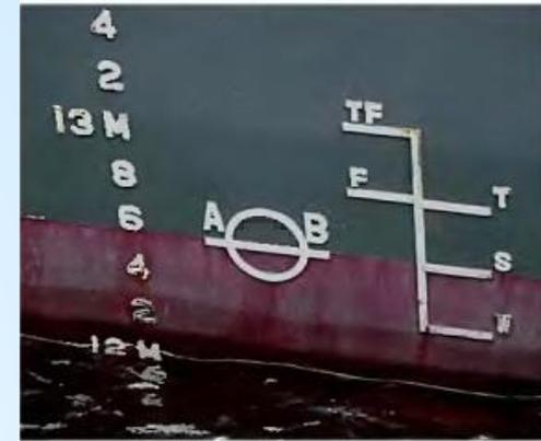
**Марки углубления** на борту судна обозначают осадку в метрах, дециметрах или футах.
