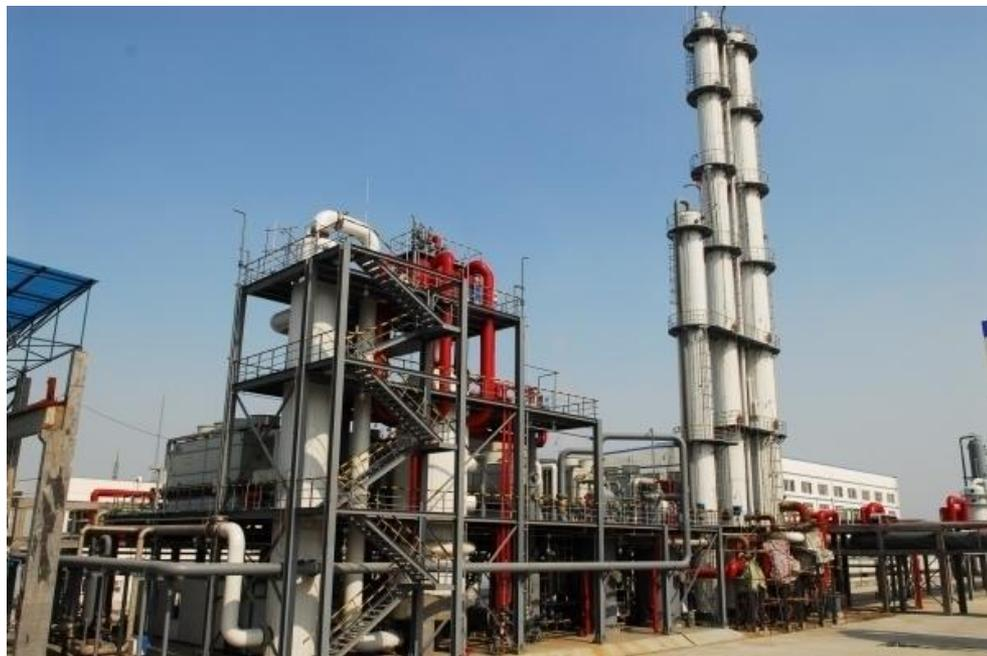
**Азотная кислота** концентрацией 55 – 60 % из цеха азотной кислоты поступает в подогреватель азотной кислоты (поз.2), где подогревается до 70 °С, но не более 100 °С. Далее азотная кислота по коллектору направляется в аппарат ИТН. Количество азотной кислоты поступающей в аппарат ИТН регулируется автоматически системой рН-метра в зависимости от количества газообразного аммиака, поступающего в аппарат ИТН с коррекцией по кислотности.
