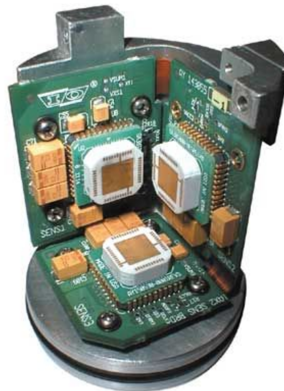
МЭМС-акселерометр для высокоточных сейсмических измерений при разведке месторождений нефти и газа (Applied MEMS)
