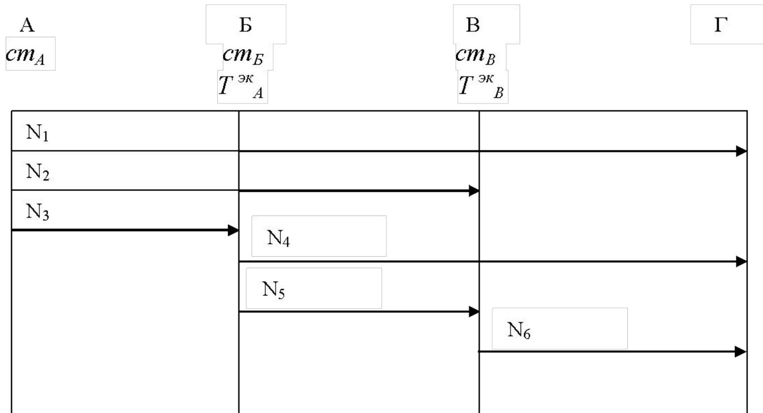
Рисунок 5.1 – Поструйный график вагонопотоков
