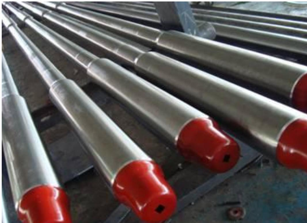
**Утяжеленные бурильные трубы** (УБТ) представляют собой толстостенные стальные трубы и предназначены для повышения жесткости и веса низа бурильной колонны с целью создания необходимой осевой нагрузки на долото в процессе бурения.
