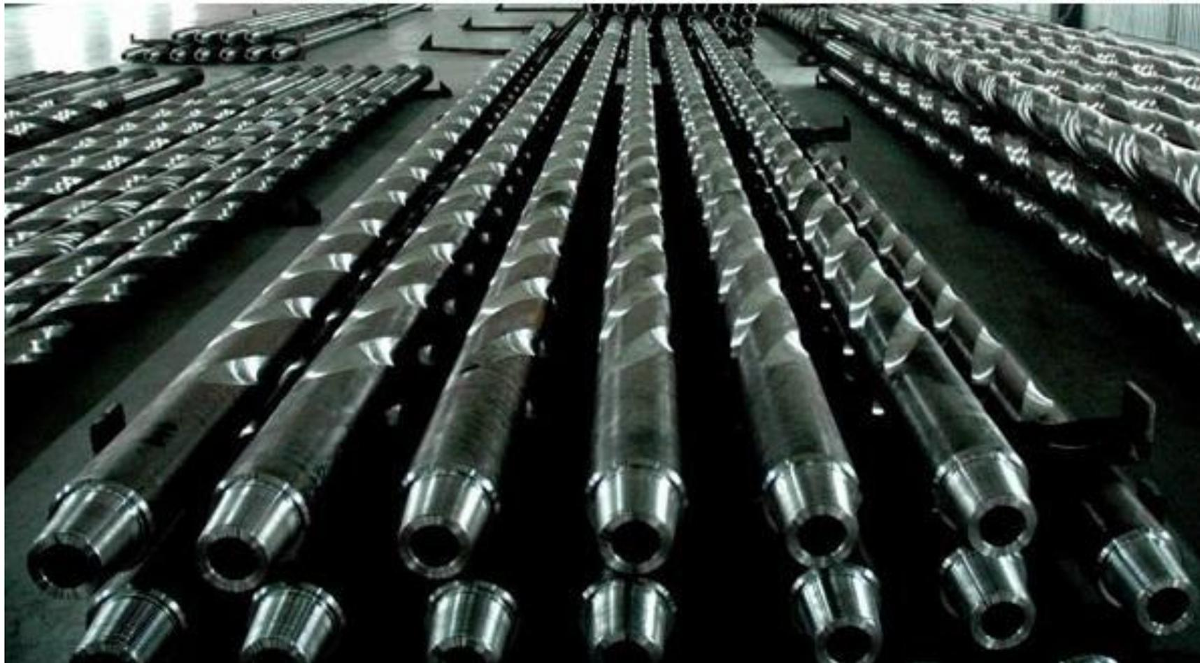
**Бурильная колонна** - связующее звено между долотом, находящимся на забое скважины, и буровым оборудованием, расположенным на поверхности.
