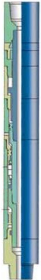
**Бурильный ясс** – это буровое оборудование, которое присоединяется к буровому инструменту и работает с бурильной колонной при заклиниваниях и освобождает заклинивший во время буровых работ инструмент. Это инструмент предназначен для использования в направленных скважинах, скважинах с осложнениями и глубоких скважинах.
