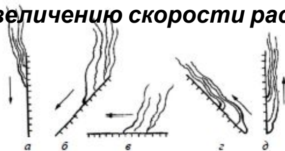
Рис. 13.3. Распространение пламени при различных углах наклона: а -90^\circ ; б -45^\circ ; в 0^\circ ; г +45^\circ ; д +90^\circ
