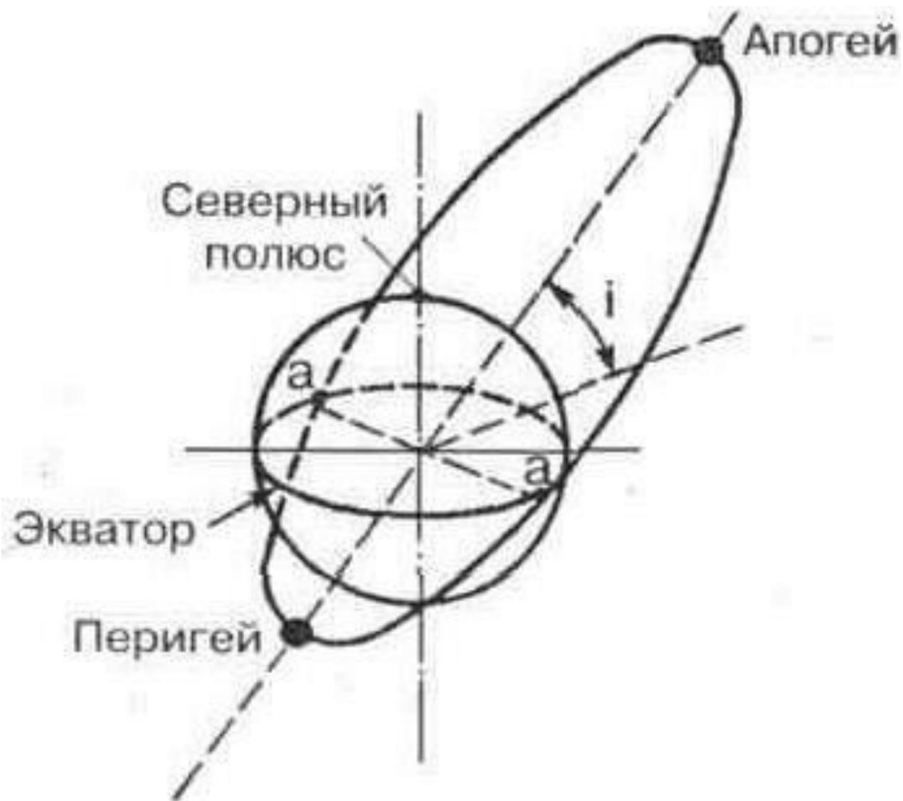
Рис. 3.1. Наклонная эллиптическая орбита ИСЗ
