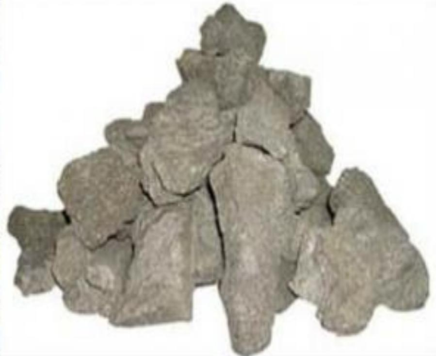
Затушенный кокс выгружается на рампу и конвейерами подается на сортировку, в зависимости от крупности спекшихся кусков делится на фракции (+60 мм, 40...60 мм, 25...40 мм, 10...25 мм, 0...10 мм и др.), затем грузится в вагоны и отправляется потребителям.
