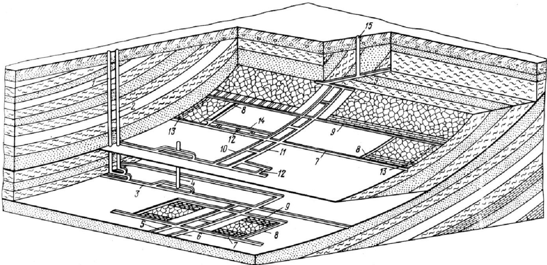
1, 2 – шахтные вертикальные стволы; 3 – главный транспортный штрек; 4 – гезенк; 5 – уклон; 6 – ходок при уклоне; 7 – транспортные штреки; 8 – лавы; 9 - вентиляционные штреки; 10 – ходок при бремсберге; 11 – бремсберг, 12 – сбойка; 13 – разрезные печи; 14 – просек; 15 – шурф
