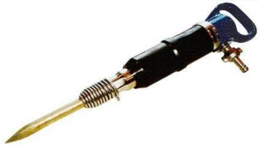
Масса 6...10 кг, подключается к пневматической линии с давлением 6 атм.
