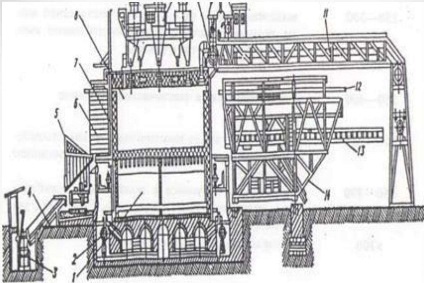
1 — регенератор; 2 — газопровод коксового газа; 3 — транспорт на коксосортировку; 4 — коксовая рампа; 5 — коксотушильный вагон; 6 — дверь съёмная машина; 7 — дверь камеры; 8 — камера коксования; 9 — загрузочный вагон; 10 — газосборщик; 11 — газопровод сырого коксового газа; 12 — планир; 13 — штанга коксовыталкивателя; 14 — коксовыталкиватель
