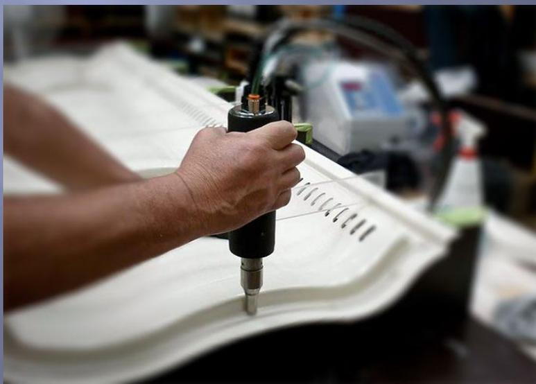
Заготовки с небольшим усилием сжимаются инструментом, на который накладываются продольные или поперечные ультразвуковые колебания.
