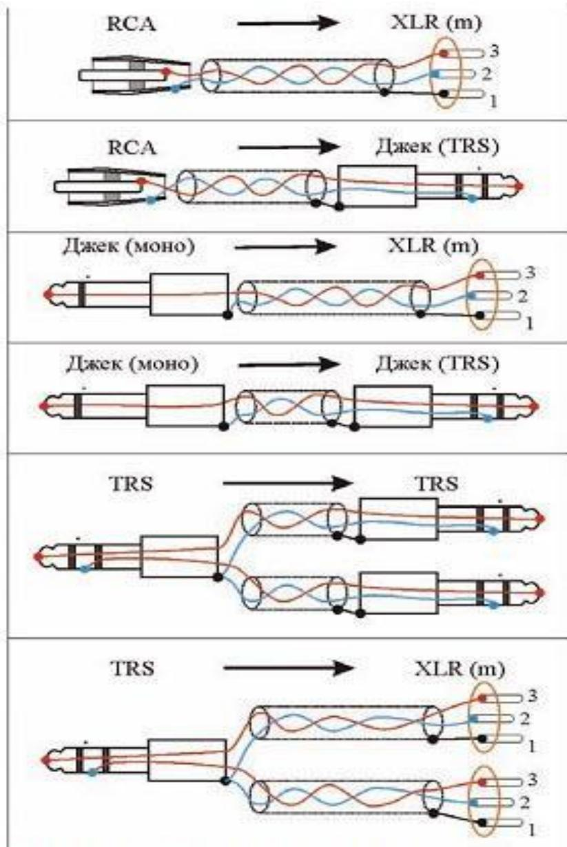
Рис. 2. Варианты расписки разъемов для подачи сигнала с небалансного выхода на балансный вход
