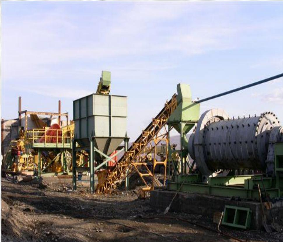
Модульные обогатительные фабрики - прогрессивное направление в области обогащения сырья. Промышленные установки такого типа предназначены для быстрого и высококорентабельного освоения месторождений металлов. Для установки модульных фабрик требуется проведение минимального объема строительных работ, что существенно снижает капитальные затраты. В комплект поставки входят металлокаркасные утепленные быстро возводимые здания.
