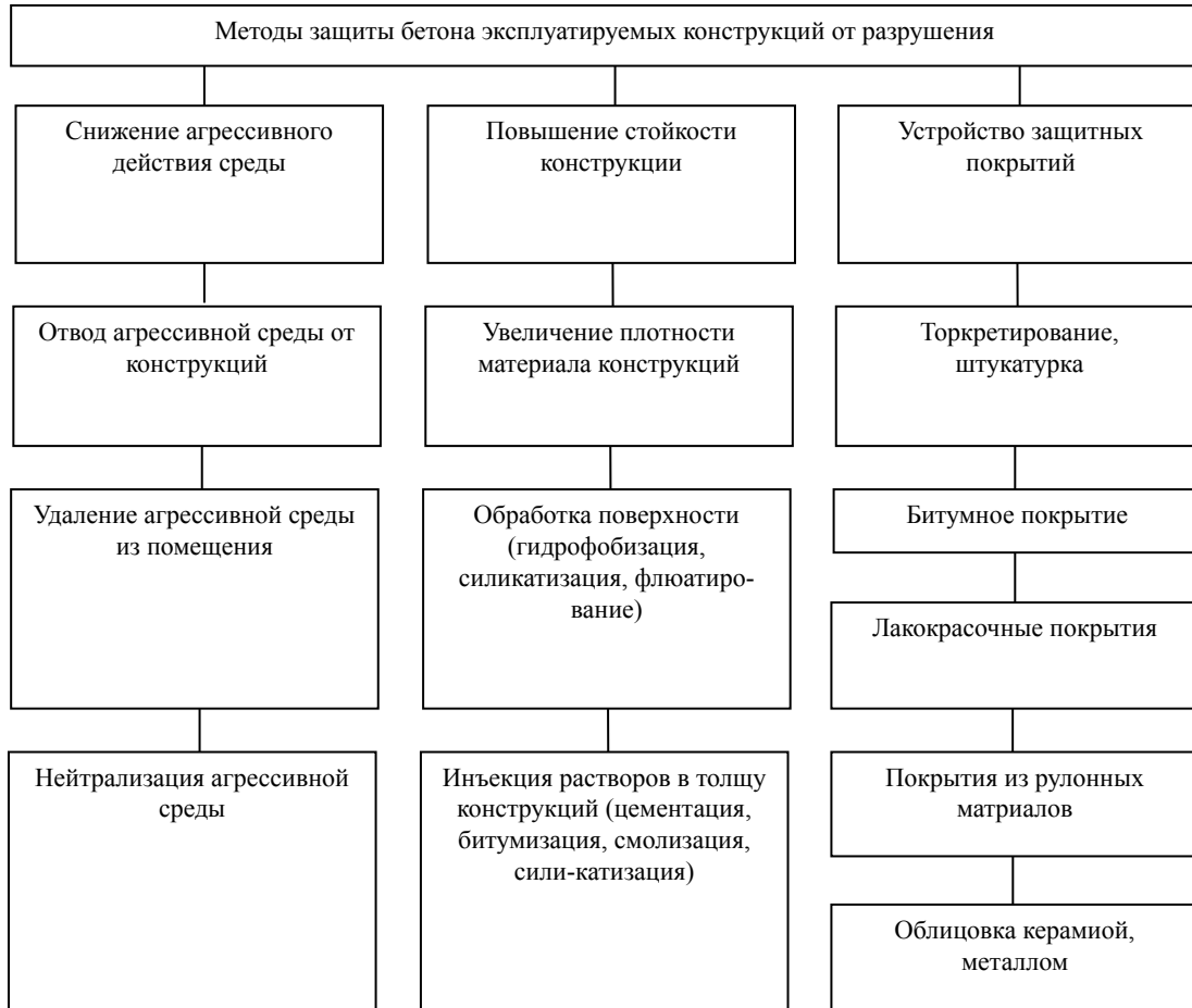
Рис. 14. Защита бетона эксплуатируемых конструкций от разрушения
