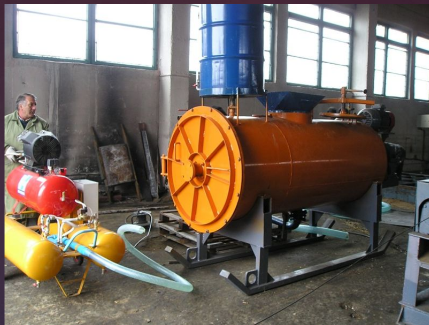
Турбулентный пенобетоносмеситель для индивидуальных производств и малых предприятий
