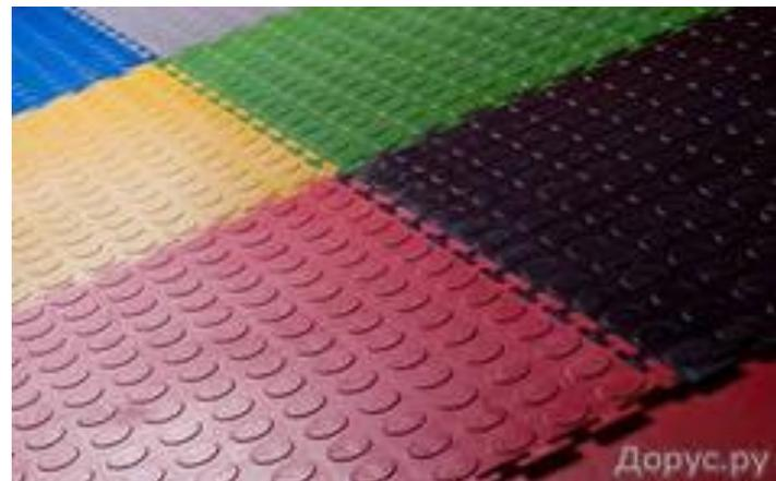
**Плитки для пола** размером 300X300 мм толщиной 2...5 мм выпускают различного цвета, что позволяет выполнять мозаичные полы. Изготавливают их чаще всего на поливинилхлоридном полимере с наполнителями, пластификаторами и пигментами.
