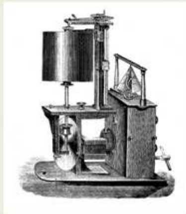
Кимограф Карла Людвига для записи колебаний кровенного давления
