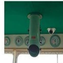
Рис. 3.2. Зеркальный отражатель магнитного компаса
