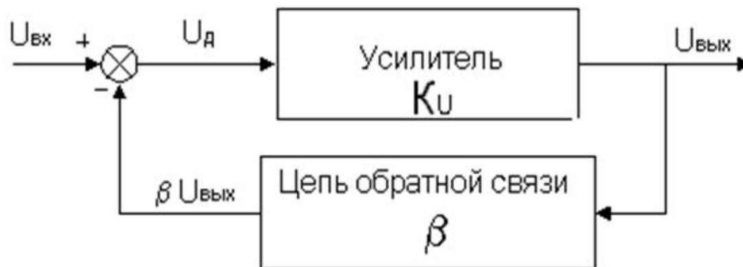
**Вывод:** коэффициент усиления ОУ с обратной связью определяется почти исключительно только обратной связью и мало зависит от параметров самого усилителя
