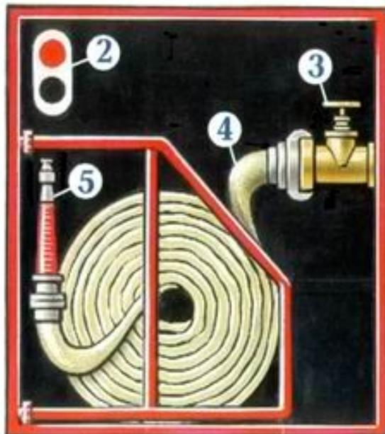
ПРЕДНАЗНАЧЕН для тушения пожаров и загораний веществ и материалов, кроме электроустановок под напряжением
