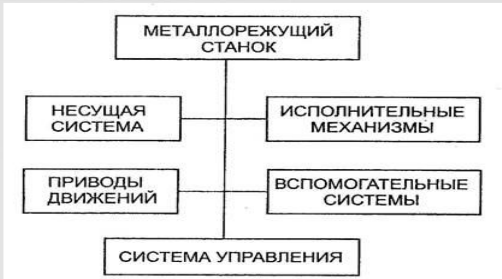
Основные составные части металлорежущего станка
