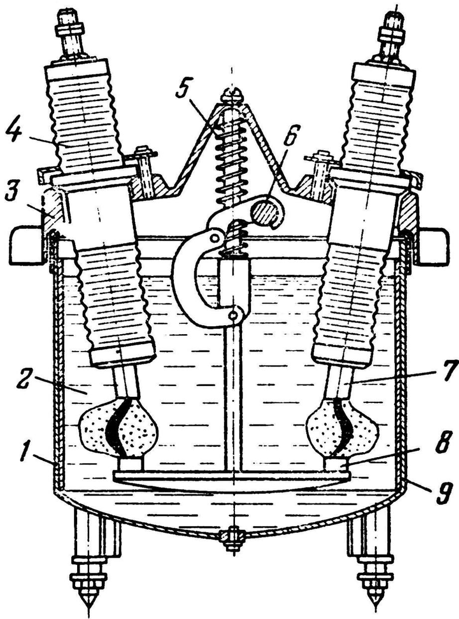
Рис. 4. Выключатель баковый
