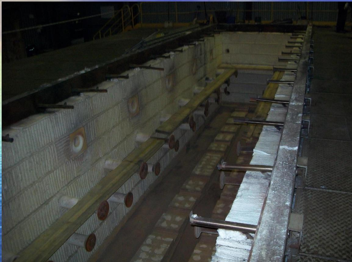
Разрушенные кирпичи на дне печи
