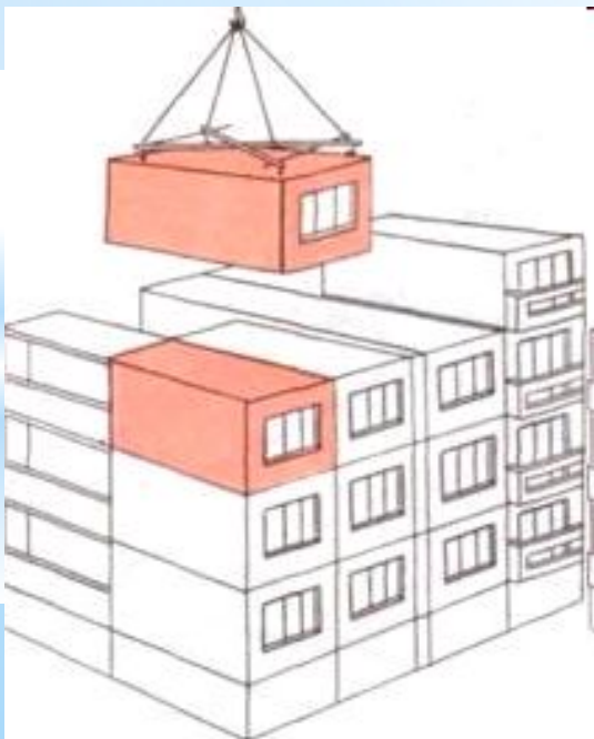
Схема домов из объемных элементов: — из блок-комнат, б — размером на две комнаты.
