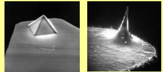
Три вида игл (каждая высотой 3 мкм)
