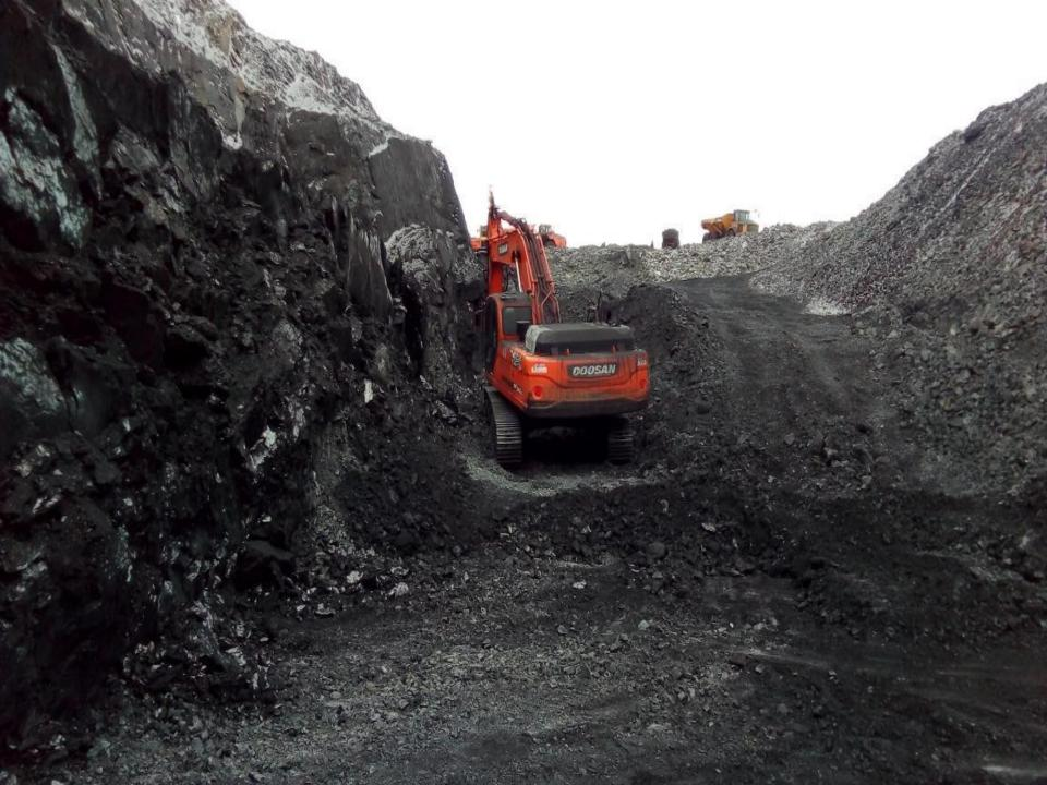
После того как осмотрели угольный пласт и если зачистили хорошо даем команду на выемку пласта.
