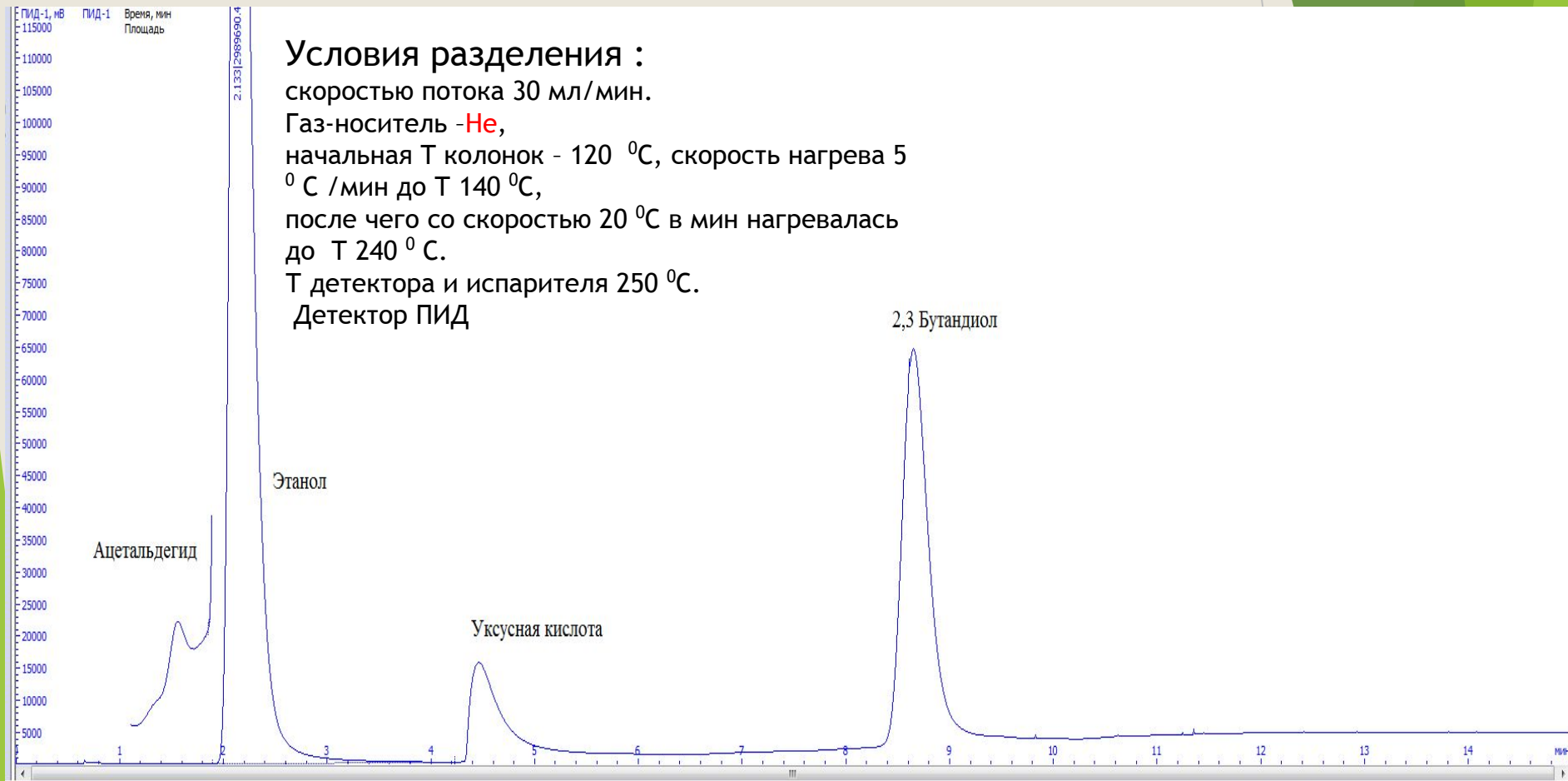
Хроматограмма раствора 2.3 БД на насадочной колонке с полистиролом
