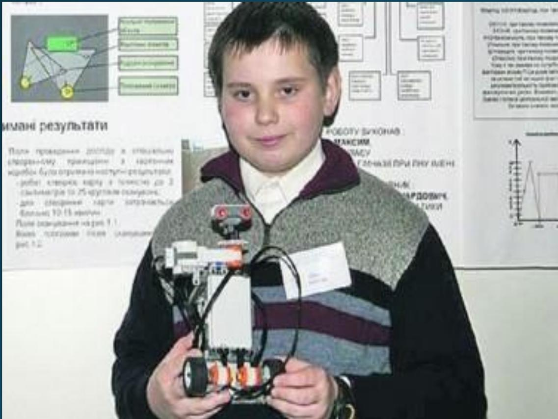
12-летний Максим Лема из Львова создал робота, выполняющего функции инженеров БТИ. Робот сканирует помещение, замеряет площадь и с помощью радиосигнала передает данные на компьютер.
