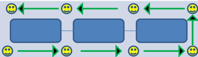
Проверяет экипажную часть, зазоры между колодками и поверхностью катания колес, состояние токоприемников, положение пневматических кранов. Между вагонами проверяет открытое положение кранов ЭКК, правильность сцепа. На хвостовой автосцепке проверяет наличие уплотнительных колец, исправность сцепного механизма, закрытое положение ЭКК.
