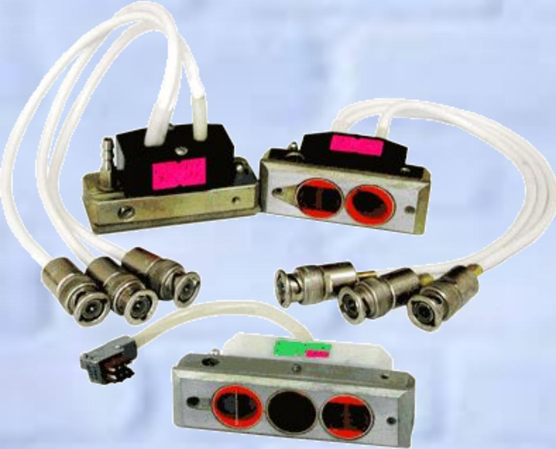
Блоки пьезоэлектрических преобразователей предназначены для совместной работы с электронным блоком дефектоскопа УДС2-РДМ-2. Используются в схемах проверки нитей железнодорожного пути.
