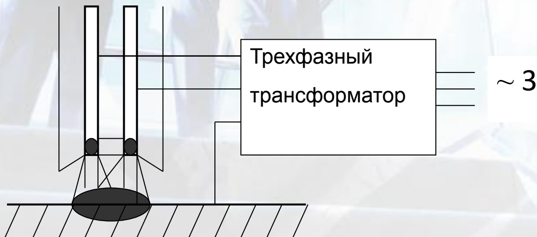
Сварка трехфазной дугой.
