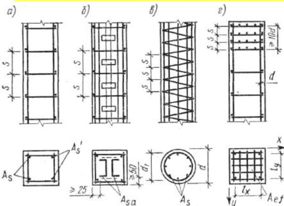
Поперечное сечение сжатых элементов, как правило, принимают: при малых эксцентриситетах — квадратное, круглое, кольцевое, при больших — прямоугольное, двутавровое. Элементы квадратного и прямоугольного сечений просты в изготовлении, но более материалоемки. Размеры поперечного сечения определяют расчетом и в целях унификации принимают кратными 50 мм, если размер сечения не превышает 500 мм, и кратным 100 мм — при больших размерах.
