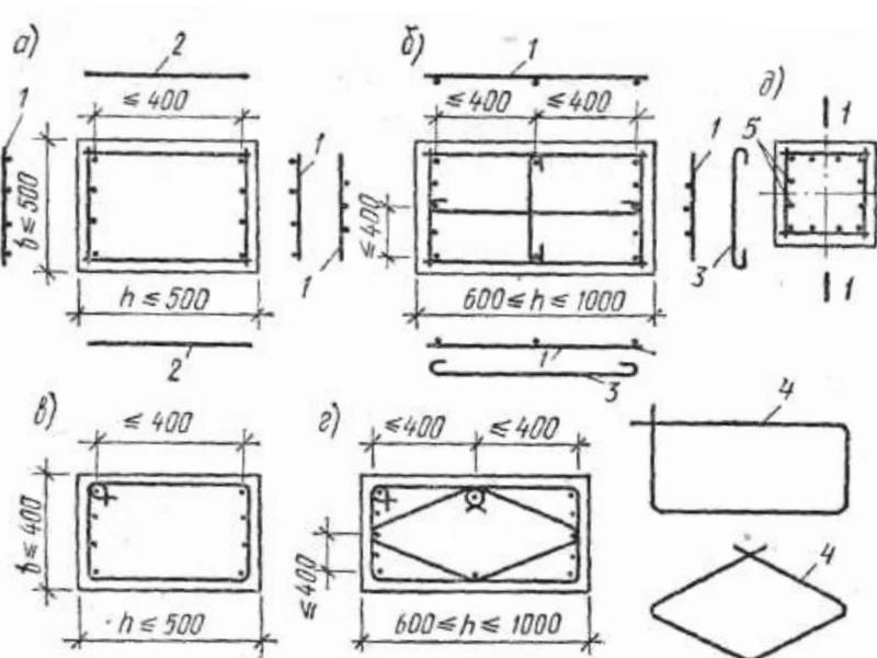
а, б, д — сварными каркасами; в, г — вязаными; / — сварные каркасы; 2 — соединительные стержни; 3 — шпильки; 4 — вязанные хомуты; 5 — промежуточные стержни; 1—1 — плоскость, в которой лежит эксцентриситет еа
