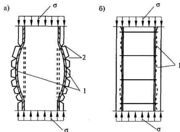
Потеря устойчивости арматуры в сжатом железобетонном элементе:
