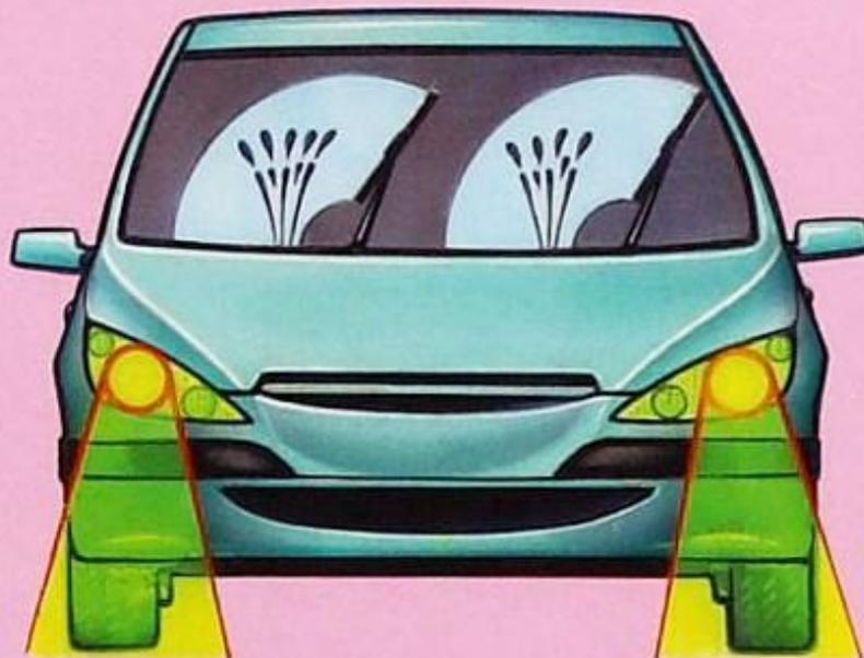
При проверке стеклоочистителей с электрическим приводом должны быть включены фары дальнего света
