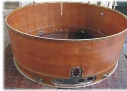
Кожух задней подвески реверса звукопоглощающей конструкции. Материал: стеклопластик СТ-69Н. Снижение массы на 11,2 кг (20%)
