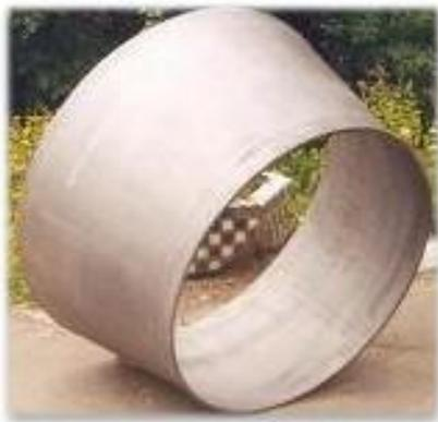
Заготовка насадки из УУКМ «Граурис» для ЖРД 11Д58-М
