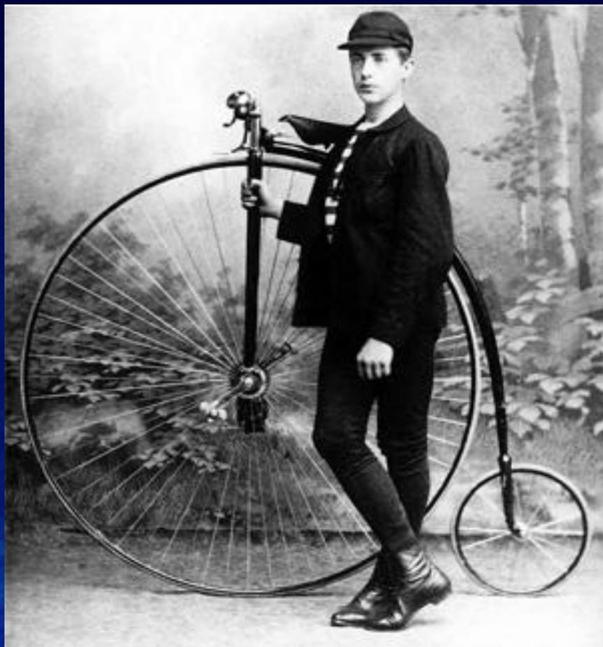
В 1867 году изобретателем Каупером была предложена удачная конструкция металлического колеса со спицами
