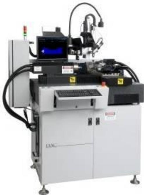
Станок для точения контактных линз.
