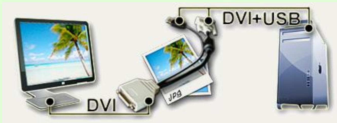
**Видеологгер** - это аппаратная закладка миниатюрных размеров, установленная в обычный видео кабель, соединяющий системный блок ПК с монитором.
