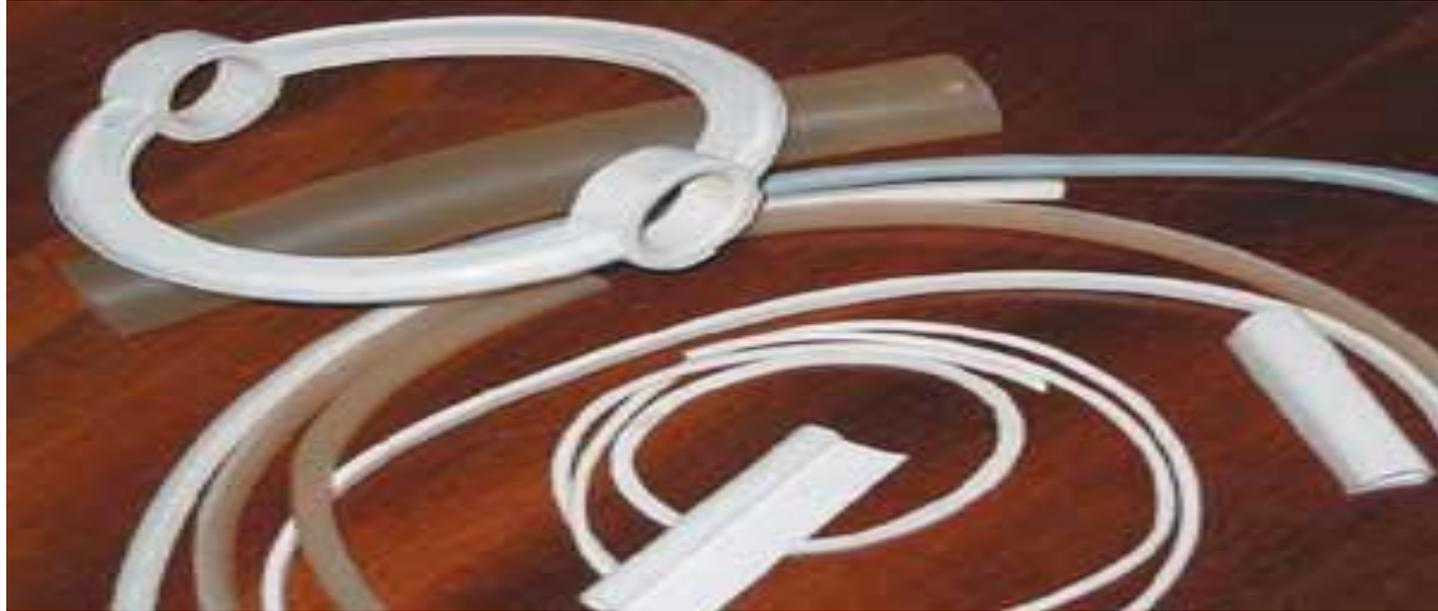
**Силоксановые резины используются для изготовления трубок, уплотнительных жгутов, профилей, колец.**
