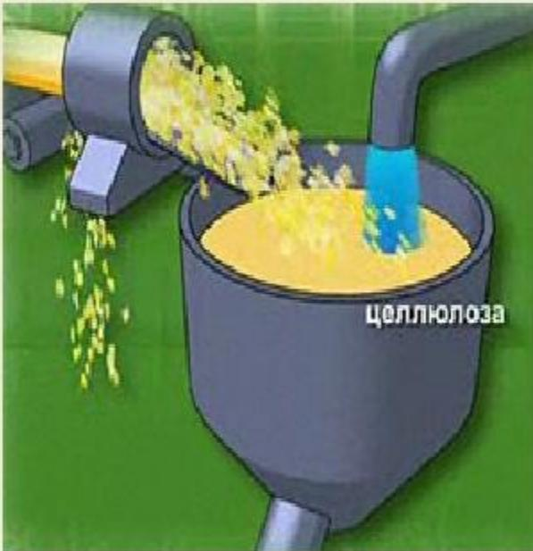
Щепки сортируют по размеру на специальных ситах и отправляют в варку. Варят дерево в специальных машинах, куда добавляют кислоту.
