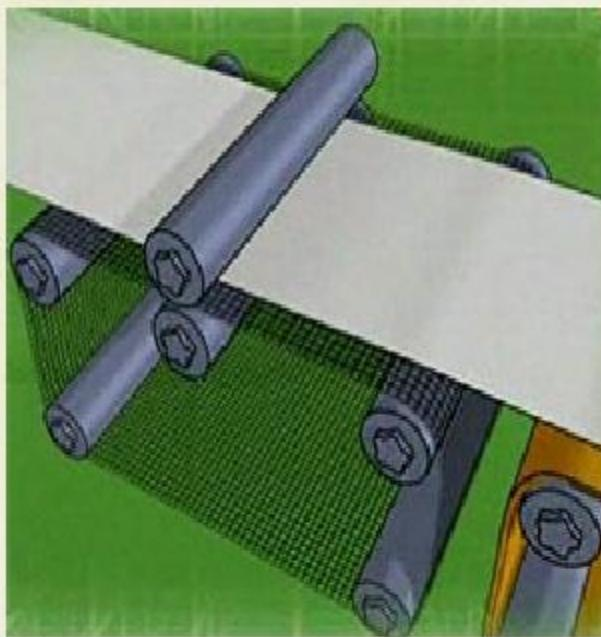
Сначала кашица выливается на сетку бумагоделательной машины. По мере продвижения бумажной массы по ленточному конвейеру часть содержащейся в ней воды вытекает через ячеистые отверстия, и бумажные волокна начинают сплетаться друг с другом, образуя так называемую рулонную ленту.
