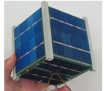
Модуль наноспутника Cubesat 1U
