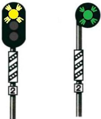
На мачте предвходного светофора устанавливается оповестительная табличка в виде трех наклонных полос с отражателями на них, которая размещается между нижним краем фонового щита и литерной табличкой.
