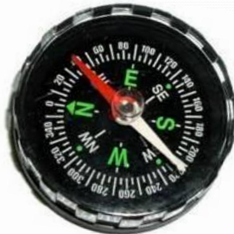
**Компас** – это угломерный прибор, который служит для измерения магнитных азимутов на местности (не на бумаге, не на карте, а в пространстве)
