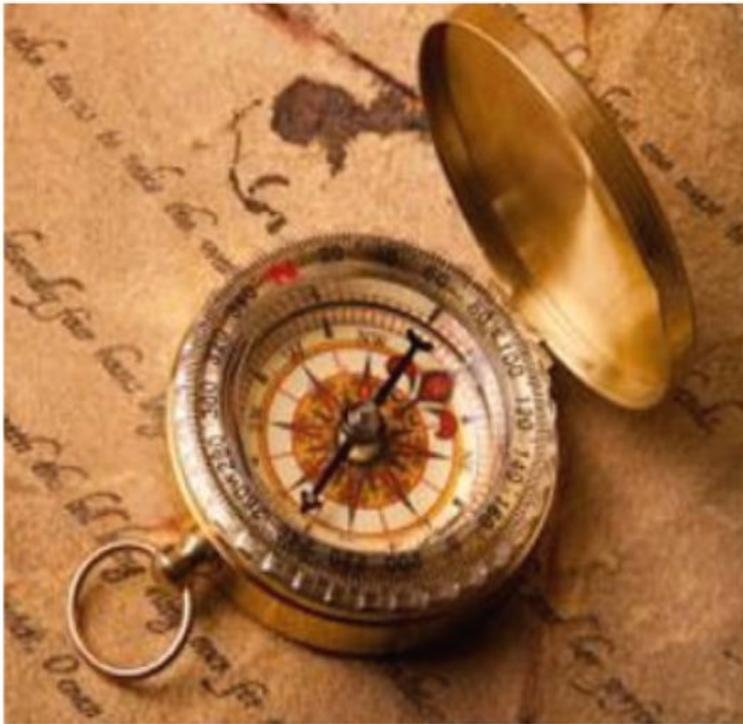
Значительно усовершенствованный вид компаса приобрёл в **начале XIV века** благодаря итальянцу **Флавио Джойя**. Он надел магнитную стрелку на вертикальную шпильку, а стрелку прикрепил к лёгкому кругу — картушке, разбитому по окружности на 16 румбов. А в XVI веке картушку и коробку со стрелкой поместили в кардановый подвес, чтобы избежать влияния качки корабля на показания компаса.
