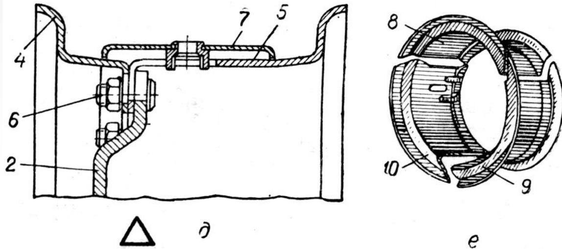
Бездисковые колеса имеют две разновидности. Одна из них имеет продольно-разборный обод и отличается от описанных выше конструкций дисковых колес отсутствием диска. Другая конструкция колеса имеет составной поперечно-разборный трехсекторный обод типа “Триллекс”, который состоит из трех секторов (рис.е).
