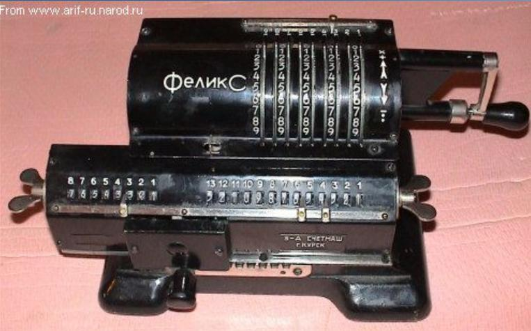
1925 г. - на Сущевском им. Ф. Э. Дзержинского механическом заводе в Москве налажено производство арифмометров под маркой "Оригинал-Однер", в дальнейшем (с 1931 г.) они стали известны как арифмометры "Феликс"
