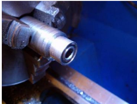
Установка вала в патроне ( L/D < 4 )
