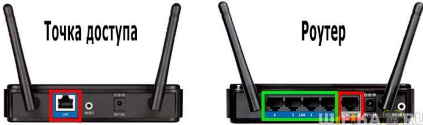
Точки беспроводного доступа обеспечивают только подключение к сети, в то время как беспроводной маршрутизатор предоставляет дополнительные возможности.
