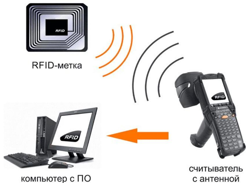
Для работы с пассивными RFID-метками требуется RFID-сканер, генерирующий радиоволны для активации и считывания метки. Пассивные RFID-метки обычно используются для сканирования на близком расстоянии, однако радиус их действия может достигать 25 м.
