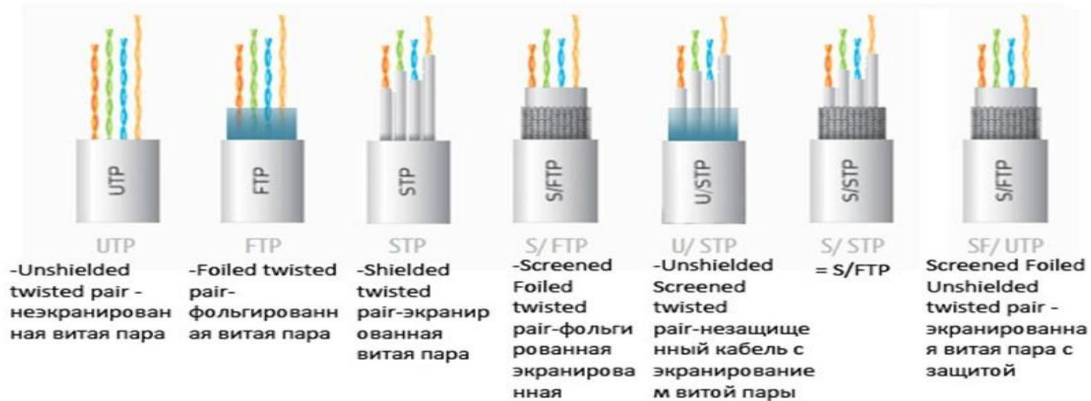
**UTP** — (Unshielded twisted pair — неэкранированная витая пара) — кабель не имеет защитного экрана.
