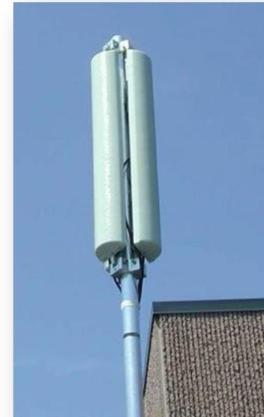
WiMAX использует передачу по УКВ (ультракоротким волнам), обычно на частотах от 2 до 11 ГГц. Волны этих частот, в отличие от волн более высоких частот, лучше преодолевают физические препятствия, поскольку они могут лучше их огибать.
