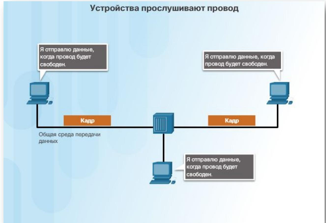
**Архитектура Ethernet основана на стандарте IEEE 802.3. Стандарт IEEE 802.3 определяет, что в сети реализуется способ контроля доступа «множественный доступ с контролем несущей и обнаружением конфликтов (CSMA/CD)».**
