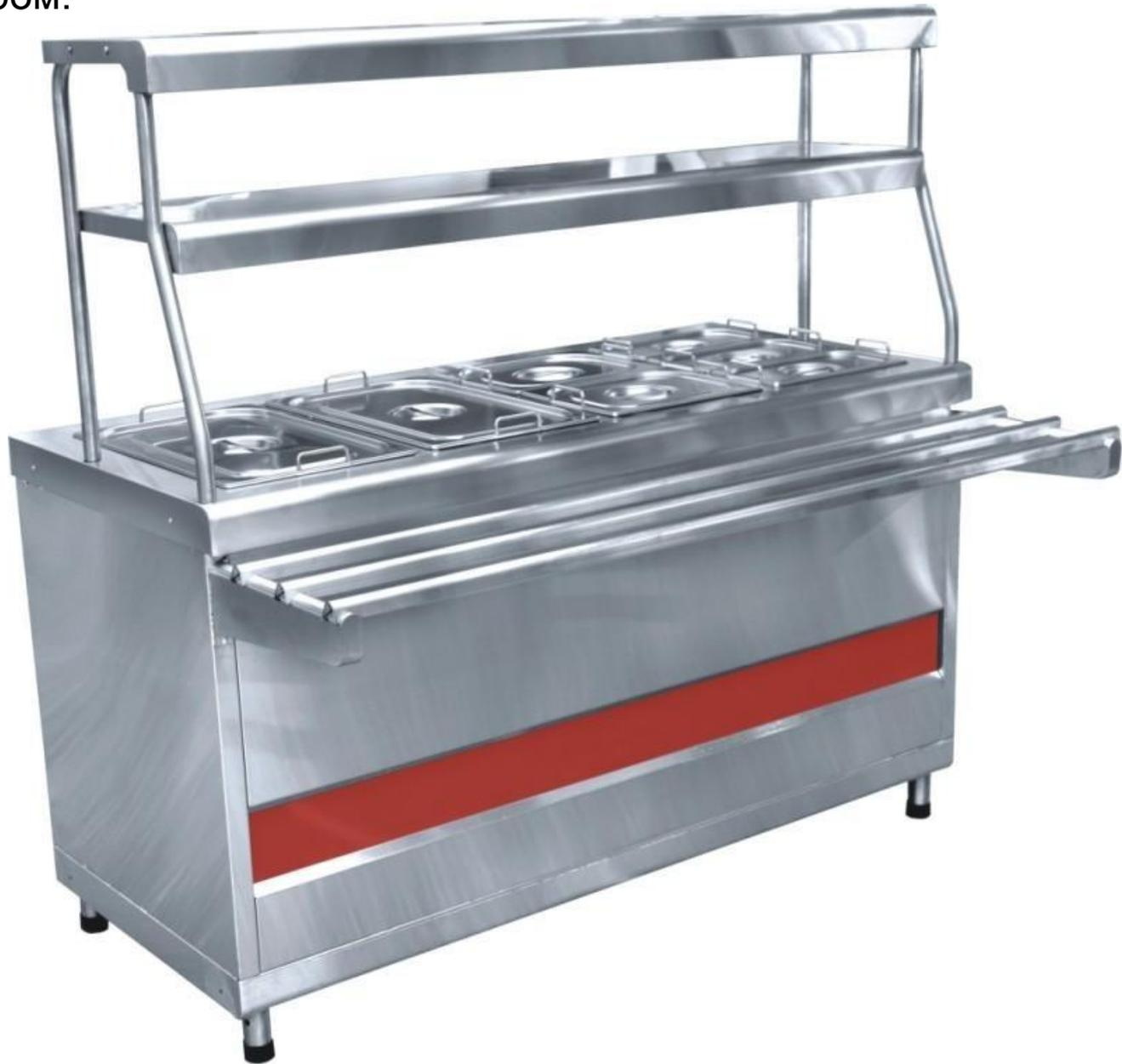
Нагрев воды осуществляется тэнами, и защиту их обеспечивает реле давления, которое срабатывая отключает тэны парогенератора, а на панели загорается красная сигнальная лампочка.
