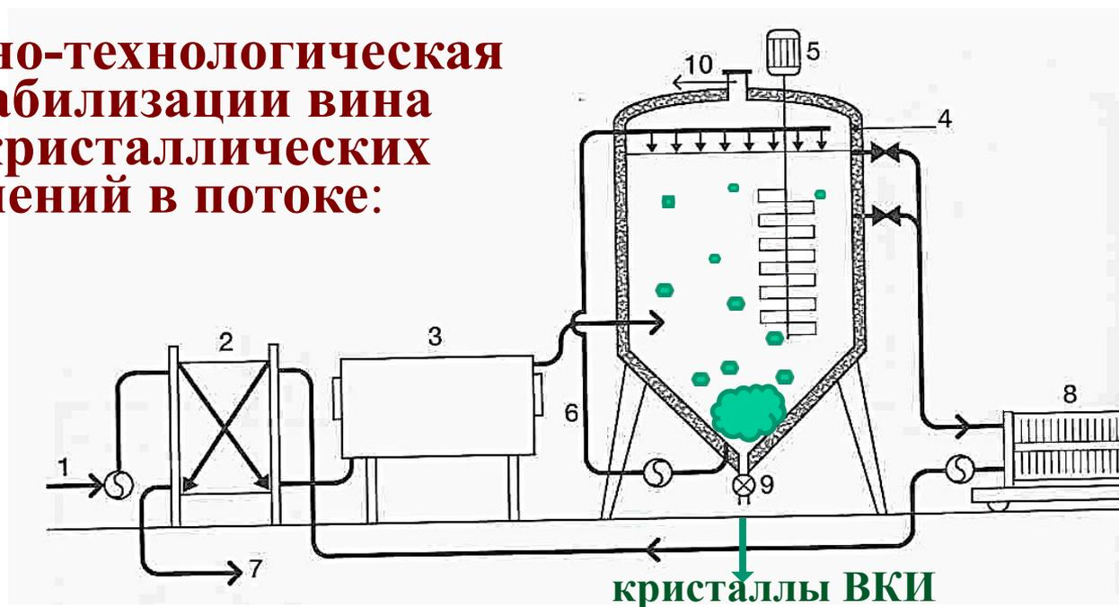
1-подача необработанного в/м; 2-рекуператор; 3-охладитель для минусовых температур; 4-реактор; 5-мешалка; 6-подаче кристаллов в реактор; 7-выход обработанного в\м; 8-фильтр; 9-вентиль для удаления кристаллов ВК; 10-верхний люк реактора
