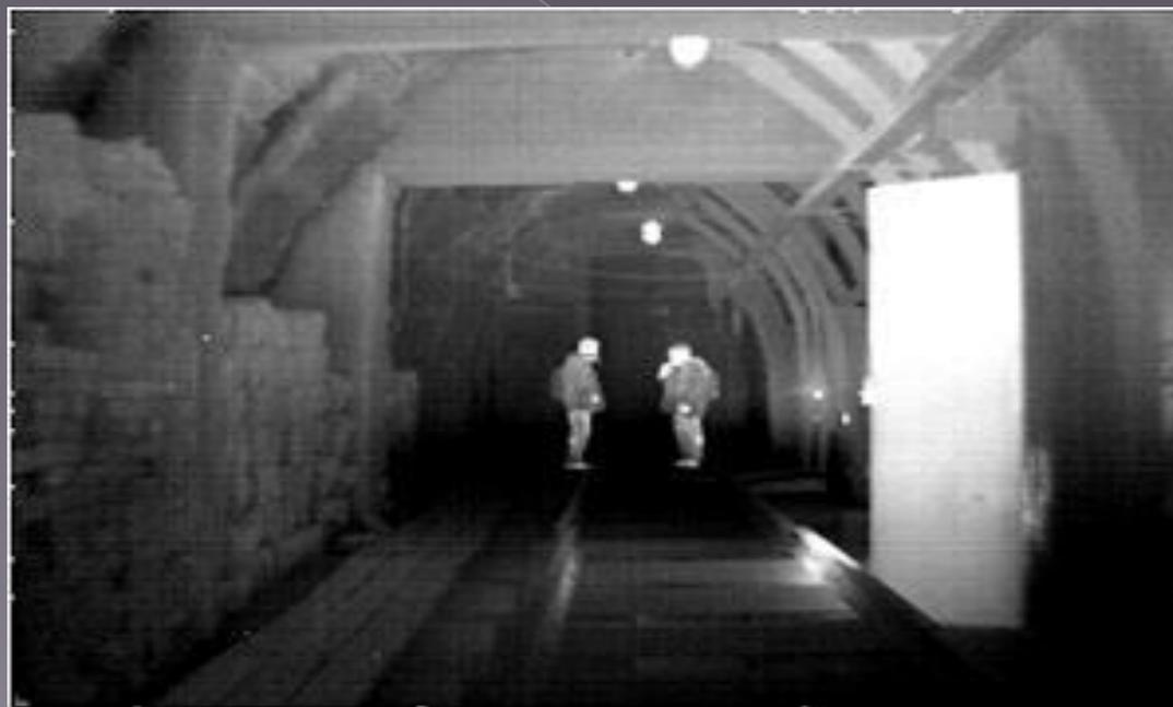
Не меньше интереса болометры вызывают у пожарных и спасателей, которым часто приходится работать в условиях практически нулевой видимости. И если шлем пожарного оборудовать таким же прибором – это значительно облегчит, например, поиск людей в задымленном помещении.
