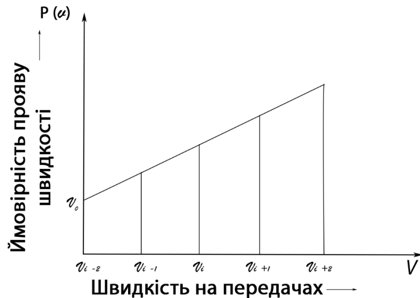
Рисунок 3 – Графік рівномірно зростаючої щільності розподілу швидкості
