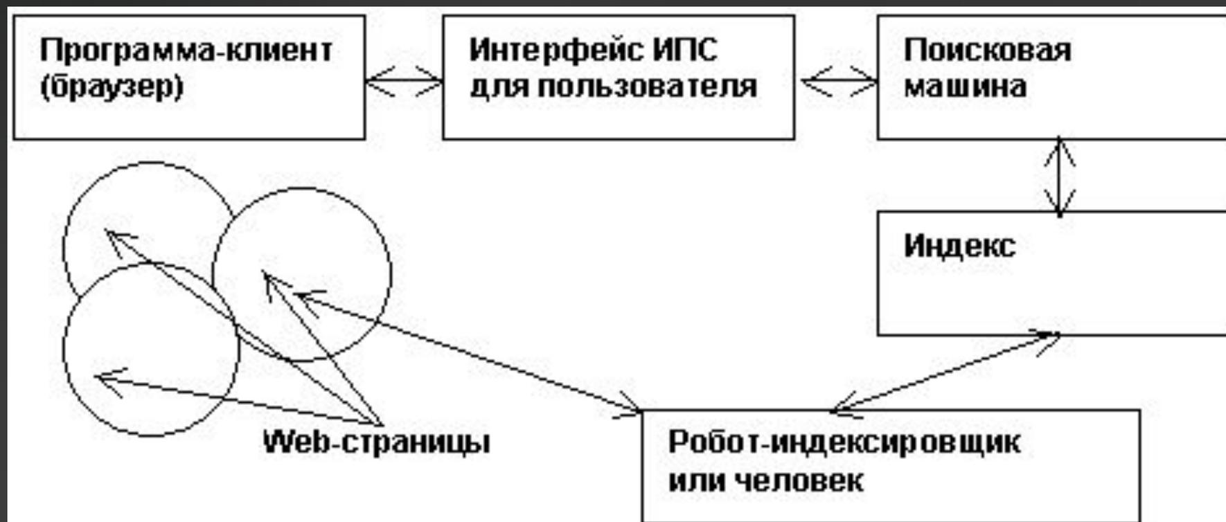
РИС. 1. СХЕМА ВЗАИМОДЕЙСТВИЯ ПОЛЬЗОВАТЕЛЯ С ИПС ДЛЯ WWW
